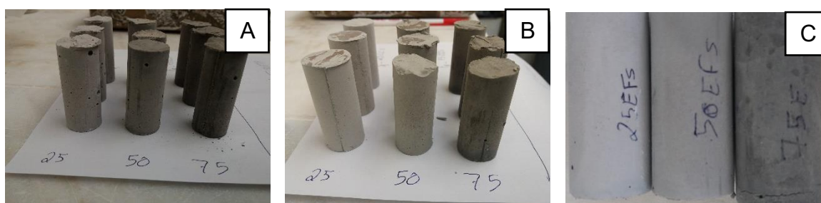
Figura 48- Coloração dos provetes do sistema ligante: A) F A_CTB ; B) F A_CCS ; C) F A_EFS .
