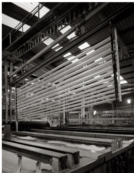
Figura 11- Etapa de anodização na Extrusal S.A. (fotografia cedida pela Extrusal S.A)
