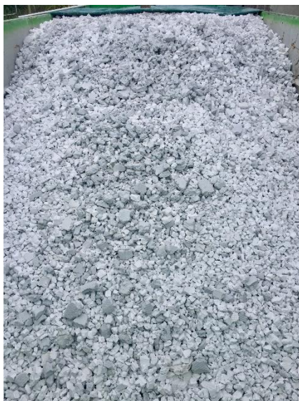
Figura 12- Lama de anodização de alumínio com ~20% de umidade relativa, após passagem por secador (fotografia cedida pela Extrusal S.A).
