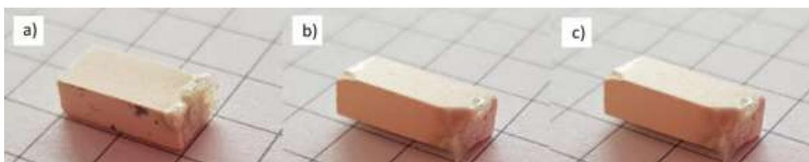
**Figura 38** – Amostras após o ensaio de FLASH isotérmico a: a) 970 °C; b) 1015 °C; c) 1060 °C.
