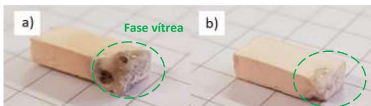
*Figura 43 – Amostras após o ensaio de FLASH: a) 5% ZnO e 0% feldspatos; b) 5% ZnO e 48% feldspatos.*
