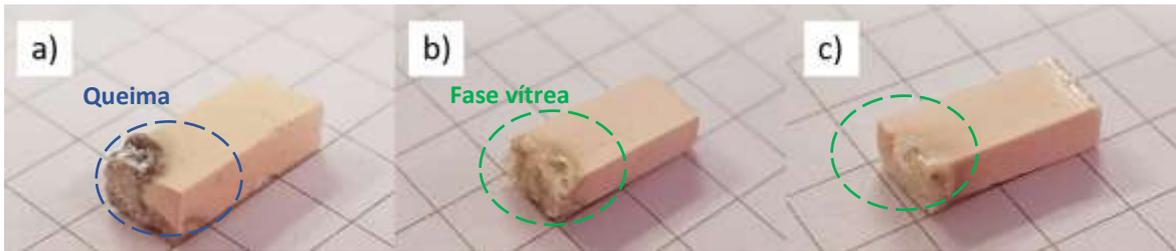
**Figura 40** – Amostras de pó com diferentes composições após ensaio de FLASH: a) 0% feldspatos; b) 24% feldspatos; c) 48% feldspatos.
