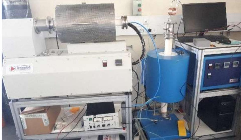
*Figura 16 – Fotografia do forno de Sinterização FLASH localizado no DEMaC.*
