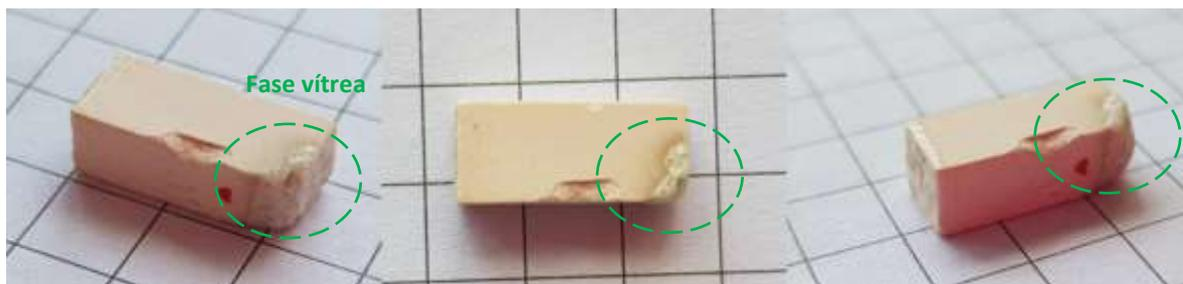
**Figura 30** – Amostra de pó atomizado após ensaio de FLASH com campo elétrico de 500 V/cm.
