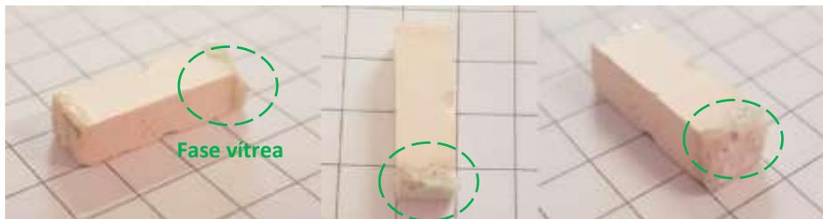
**Figura 28** – Amostra de pó atomizado após ensaio de FLASH com campo elétrico de 350 V/cm.
