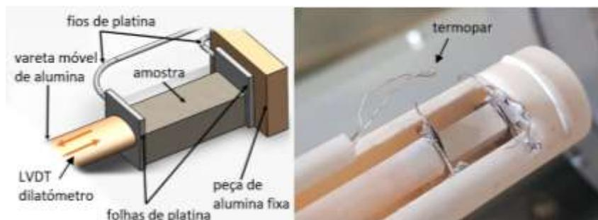
*Figura 17 – Configuração experimental da montagem da amostra no forno.*
