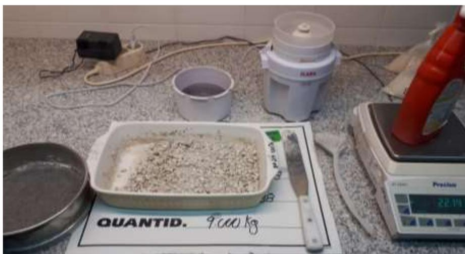
**Figura 14** – Fotografia da configuração experimental da moagem do material esmagado.
