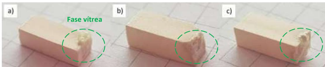
**Figura 35** – Amostras de pó atomizado após o ensaio de FLASH com campo elétrico de 500 V/cm que foram previamente calcinadas a: a) 850 °C; b) 900 °C; c) 950 °C.
