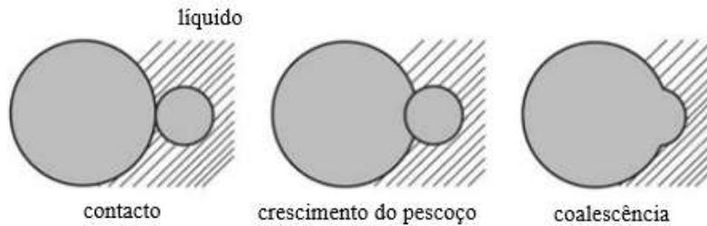
**Figura 6** – Esquemática do mecanismo de coalescência (adaptado de [12]).
