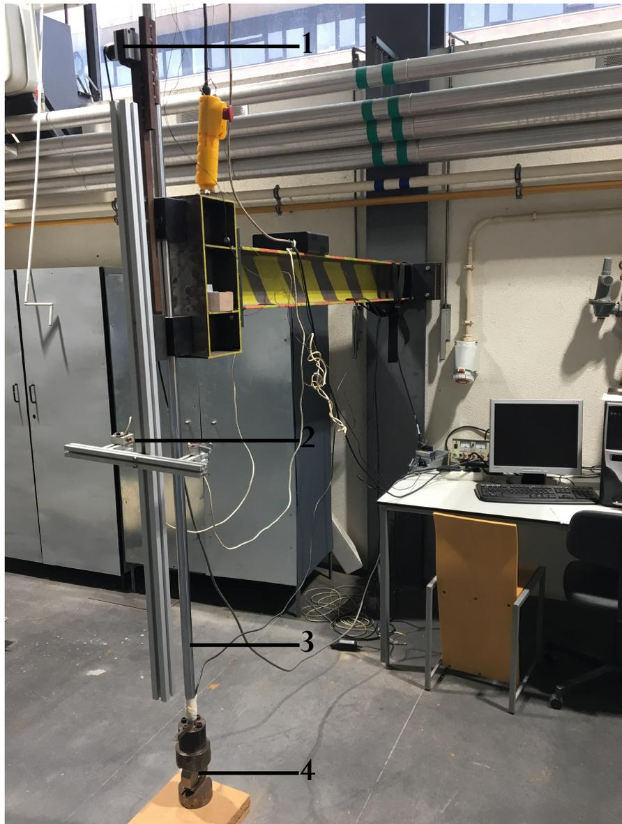
Figura 2.1: Máquina de ensaios de impacto utilizada - 1) *Encoder* de fio; 2) Laser corta corrente; 3) Varão metálico 4) Célula de carga
