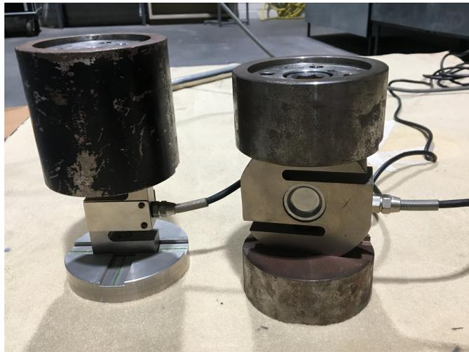
Figura 2.2: Célula de carga de 5 kN (à esquerda) e de 20 kN (à direita) com as respectivas peças de encaixe
