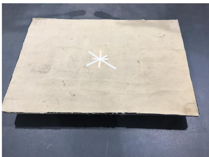
Figura 2.10: Ponto de impacto utilizado durante os ensaios realizados
