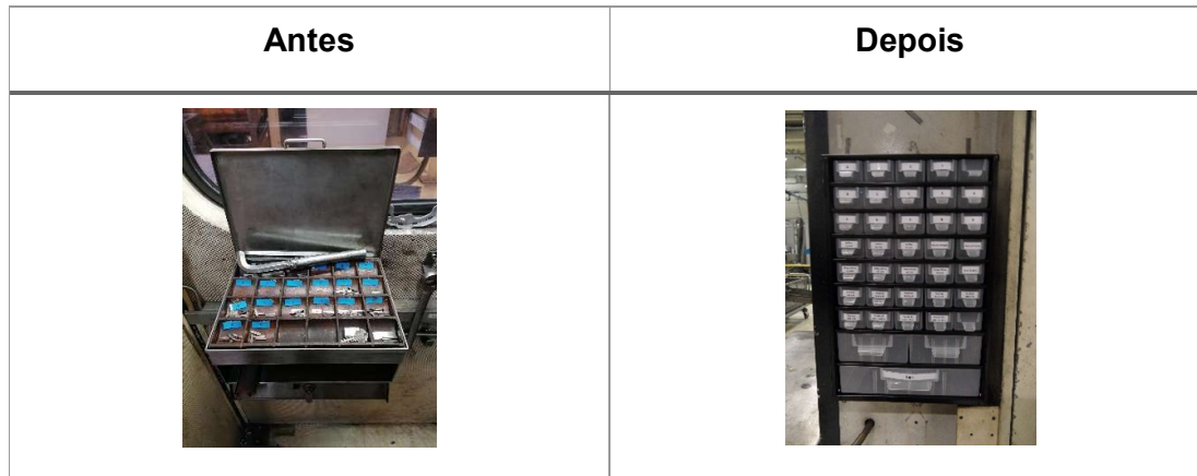
Figura 60. Exemplo de melhoria do 5S. Antes vs. Depois (punções de marcação)
