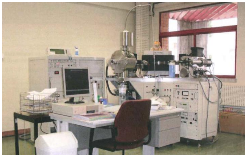
Figura 32. Espectrómetro de massa de ionização térmica (TIM), modelo VG Sector 54, do Laboratório de Geologia Isotópica da Universidade de Aveiro.
