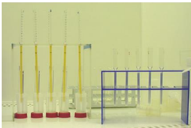
Figura 31. Imagem das colunas de cromatografia primária e secundária do laboratório de geologia isotópica da Universidade de Aveiro.
