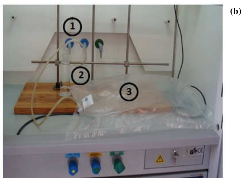
Figura 7- Esquema (a) e Foto (b) da montagem experimental para a obtenção de formaldeído no estado gasoso.
