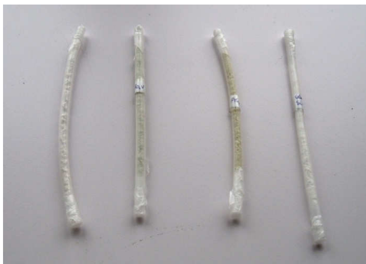
Figura 6: Materiais híbridos de: (a) celulose-sílica, (b) e (c) celulose-sílica incorporando PMO 11 V e PMO 10 V 2 , respectivamente e (d) celulose-sílica com o grupo amino associado.
