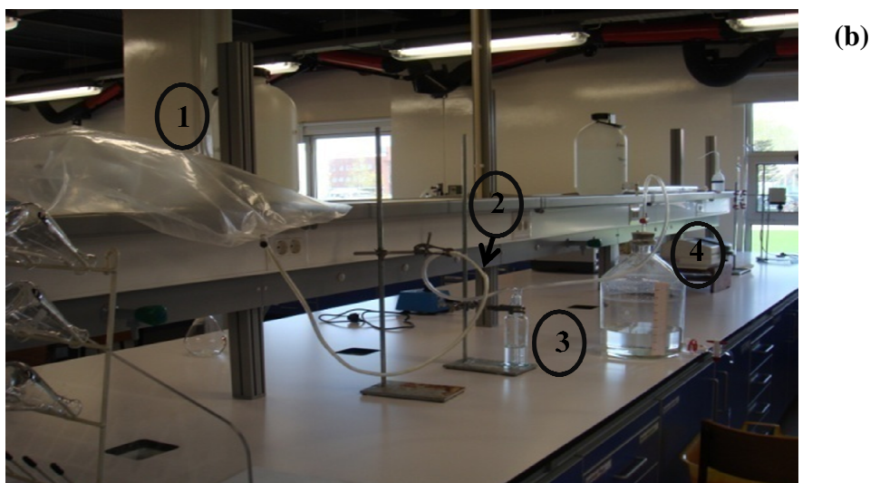
Figura 10- Esquema (a) e foto (b) da montagem experimental do processo de oxidação do formaldeído.
