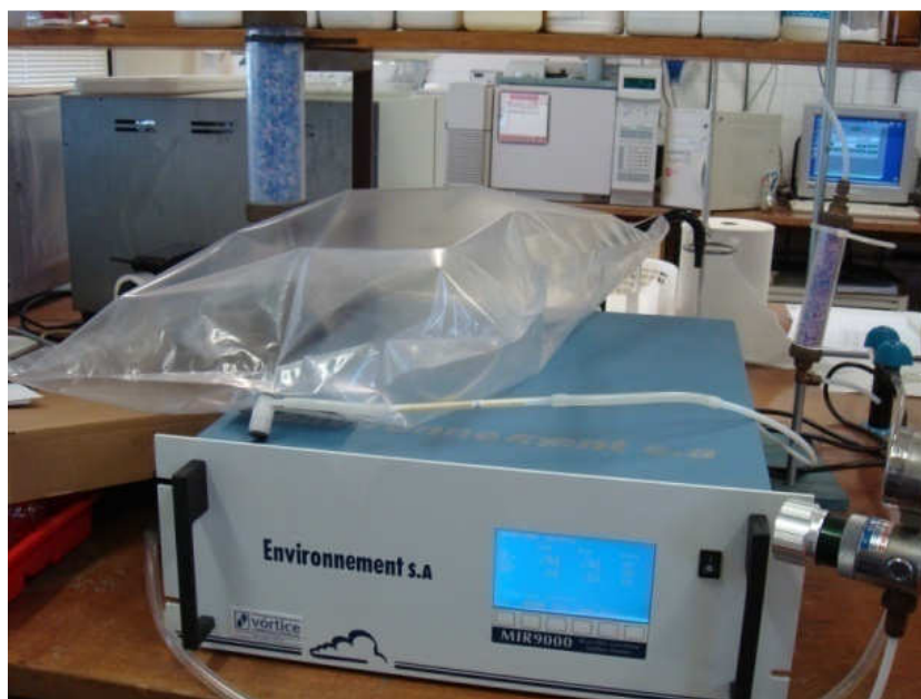
Figura 9- Montagem experimental para os ensaios efectuados com CO.
