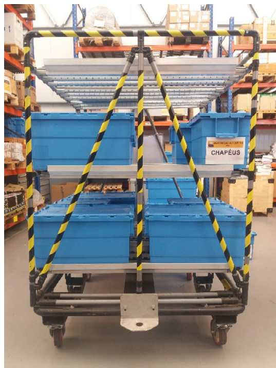
Figura 62: Base rolante com três prateleiras, onde é fácil mover as caixas, utilizada para transportar os artigos a distribuir pelos respectivos setores/pontos de entrega.
