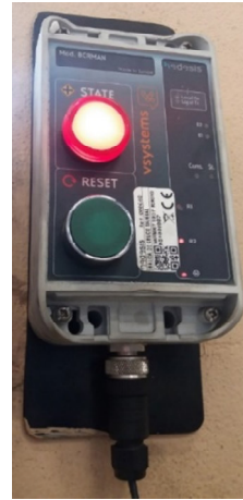
Figura 27: Baliza a sinalizar que o cruzamento está ocupado e que é necessário esperar que a passagem fique livre para que o AGV possa avançar.
