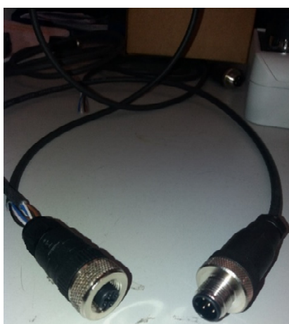
Figura 66: Cabo de ligação entre a baliza e o pirlampo.
