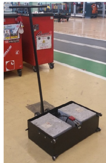
Figura 33: Bateria do AGV e ferramenta necessária para deslocação da mesma.
