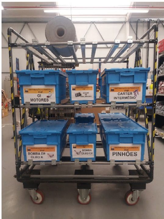
Figura 62: Base rolante com três prateleiras, onde é fácil mover as caixas, utilizada para transportar os artigos a distribuir pelos respectivos setores/pontos de entrega.
