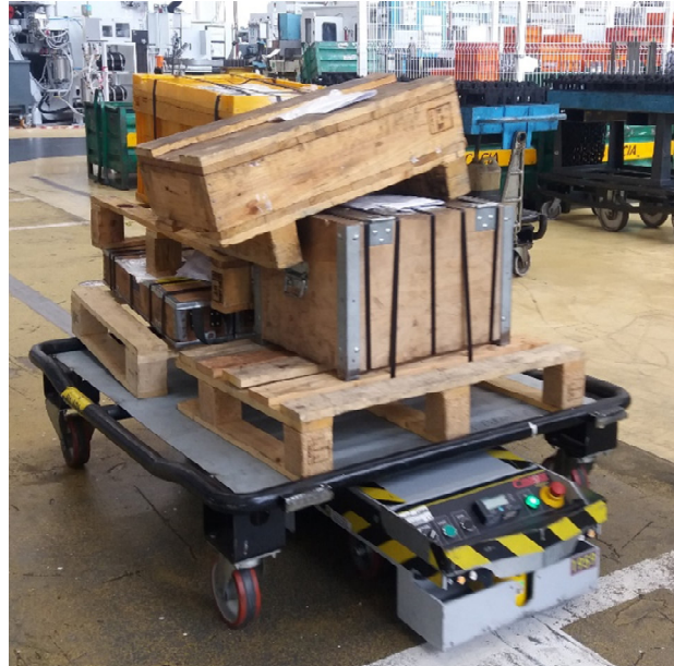
Figura 60: AGV a transportar equipamentos e material que é preciso levar do CGO até ao armazém PHF.
