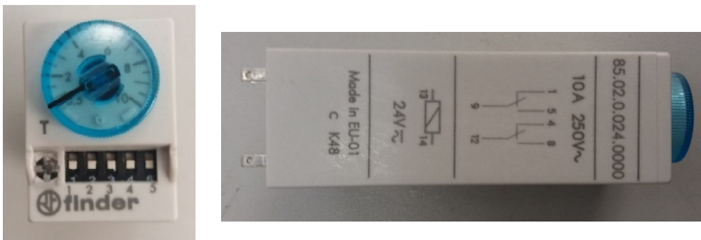
Figura 65: Relé de ativação do pirlampo aquando da chegada do AGV ao setor/ponto de descarga.
