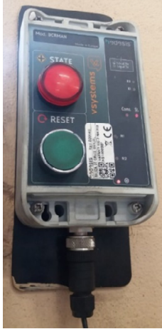
Figura 26: Baliza a sinalizar que o cruzamento está desimpedido e qualquer AGV pode avançar.
