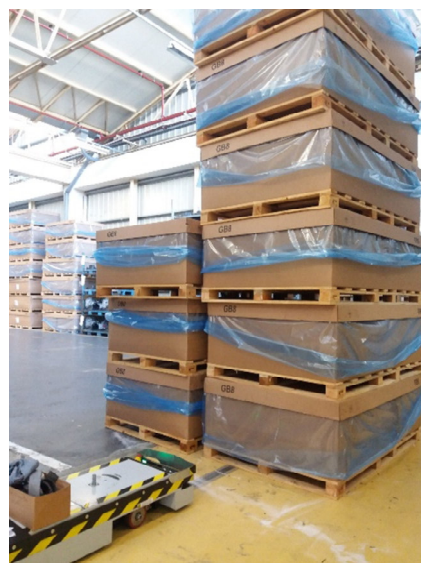
Figura 46: Exemplo de uma situação em que o AGV está parado devido à presença de um obstáculo.
