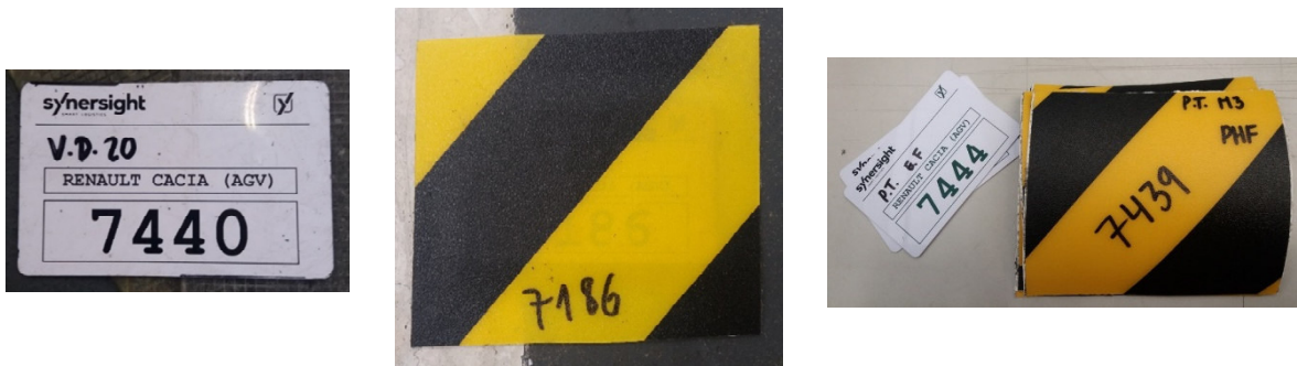
Figura 28: Exemplo de tags e fita protetora que serve de revestimento para impedir que a tag seja danificada ou arrancada.
