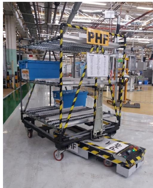
Figura 25: AGV do armazém PHF com a respetiva estante de transporte de artigos atrelada, pelo novo mecanismo implementado.
