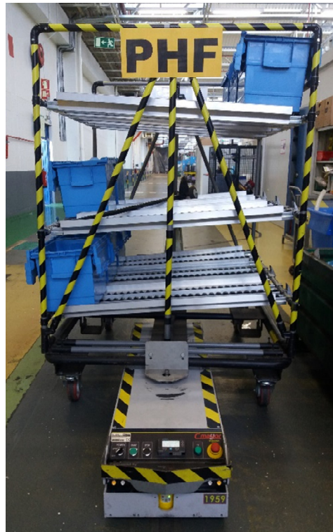
Figura 20: AGV e respetiva base rolante, atrelada, com as caixas de transporte de artigos.
