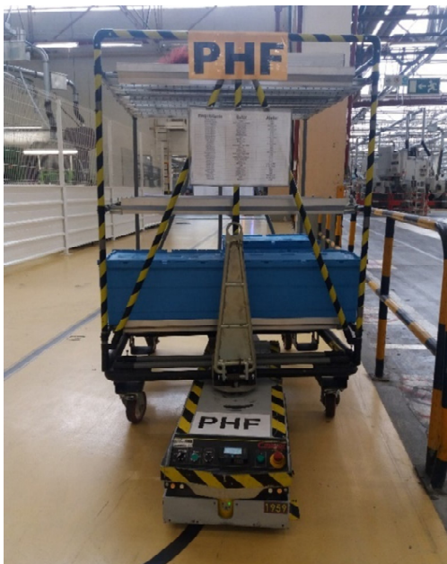
Figura 25: AGV do armazém PHF com a respetiva estante de transporte de artigos atrelada, pelo novo mecanismo implementado.
