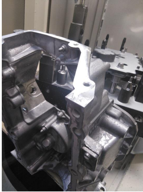
Figura 34 - Carter maquinado sem evidência de rebarba após o ensaio realizado
