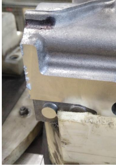
Figura 30 - Evidência de rebarba na junção das faces 500 e 100 do Carter Intermédio
