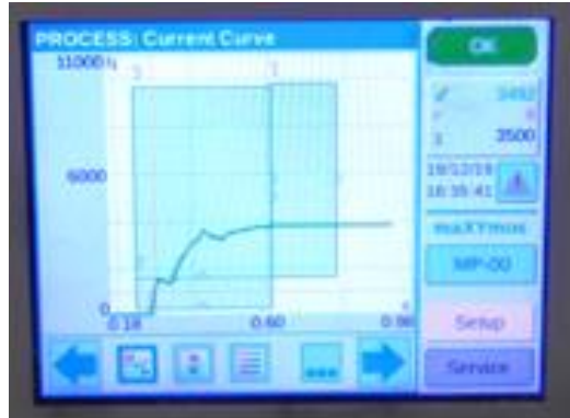
Figura 35 - Gráfico que mede o esforço de inserção do tampão na peça
