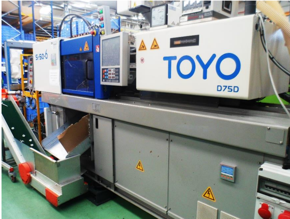
Figura 20: Máquina de Injeção de Plástico TOYO (MIP 126)
