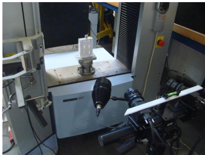
Figura 47 - Montagem do protótipo no sistema Aramis.
