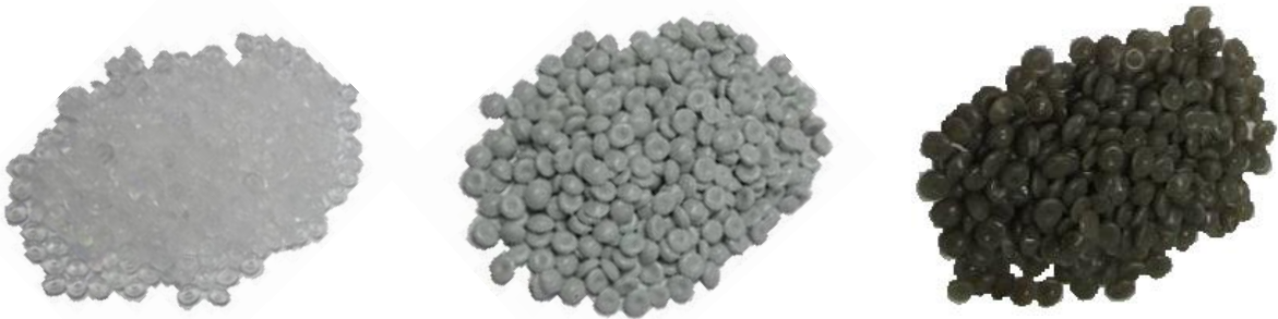
Figura 16: Amostras de granulado: À esquerda MP virgem, no centro e à direita MP recicladas.
