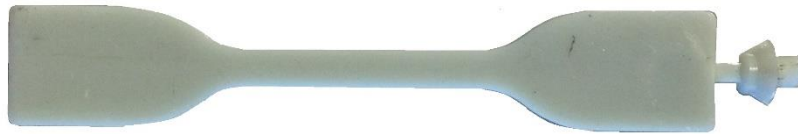
Figura 18: Provetes do tipo 5A (ISO 527-2:2012)
