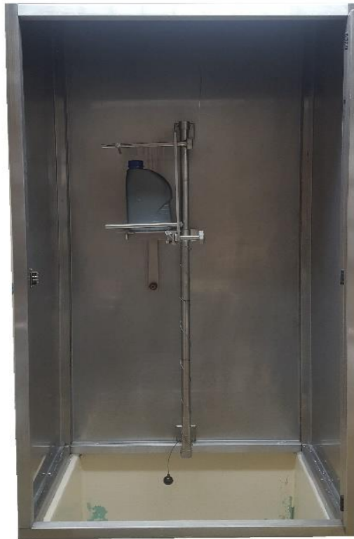
Figura 24: Cabine de ensaios de impacto
