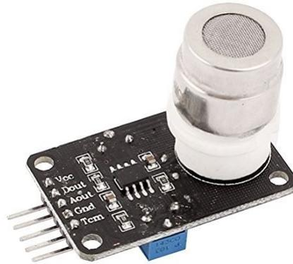
Figura 4.15: Placa com MG811 e circuito de condicionamento de sinal
