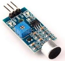
Figura 4.20: Módulo sensor de som
