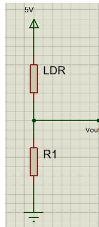
Figura 4.17: Esquema elétrico de um sensor LDR
