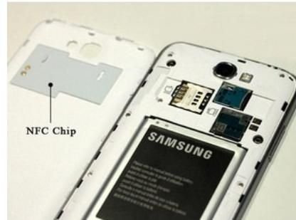
Figura 2.11: Tecnologia NFC integrada em *smartphone*
