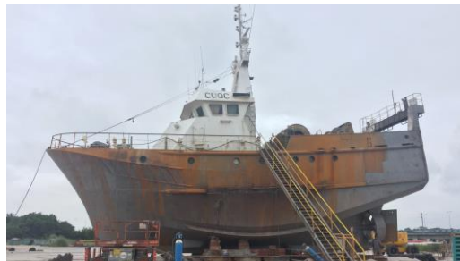
Figura 3 – Fotografias do processo de limpeza dos navios por jato de granalha na NavalRia.
