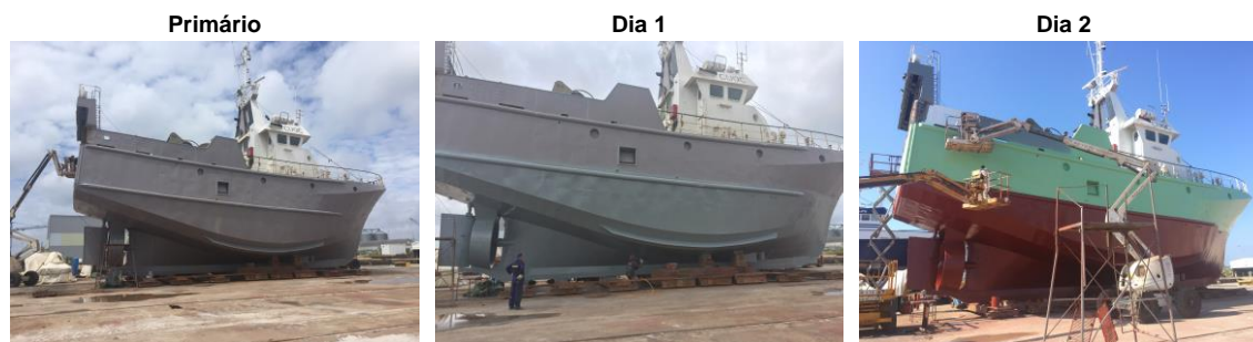
Figura 5 – Fotografias do processo de pintura dos navios na NavalRia.
