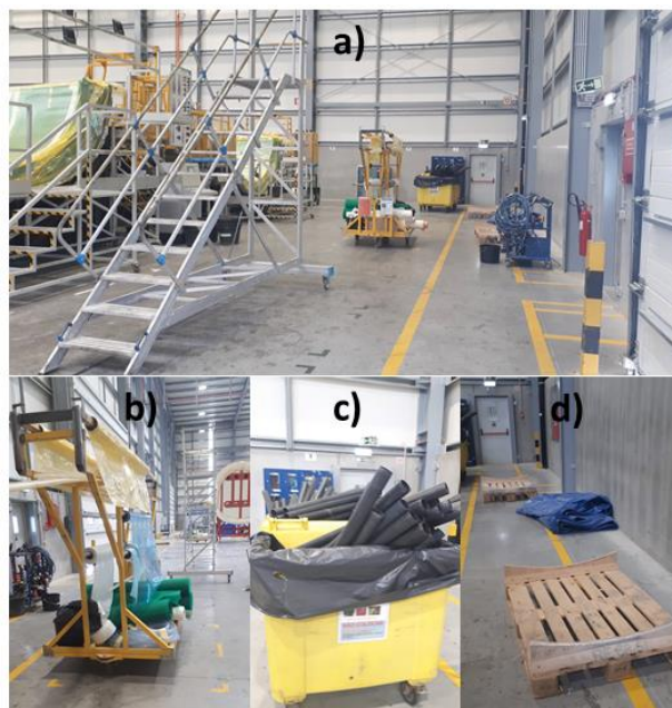
Figura 19: Desorganização da área (MS RE68.5) – a) visão geral da área; b) carro de layup no turno de colagem; c) tubos de fibras em contentores amarelos; d) paletes de transporte de root joints no corredor de segurança
