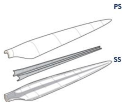
Figura 14: Representação de componentes de uma pá eólica
