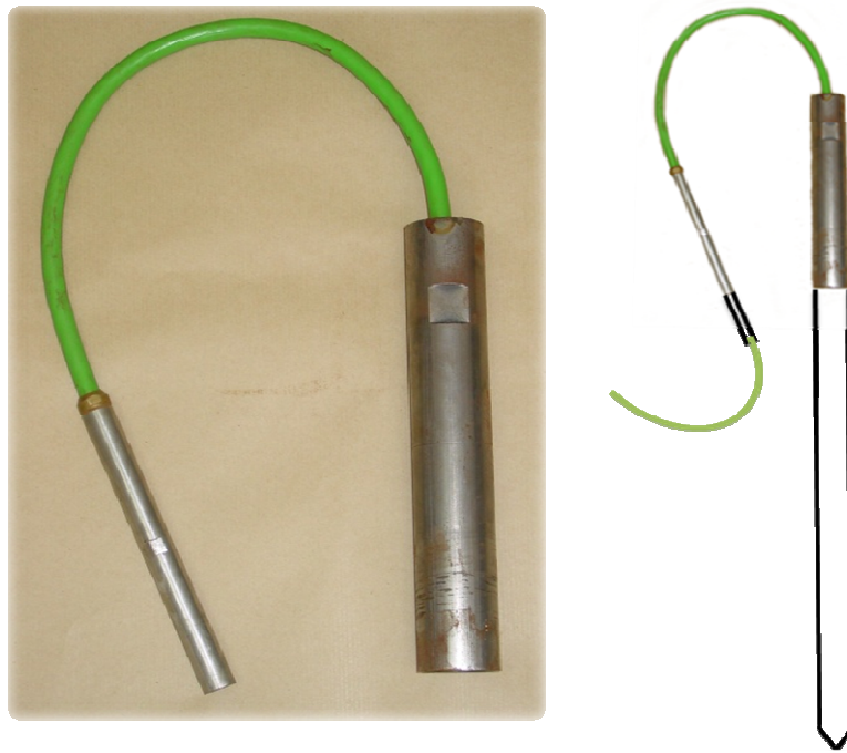
Figura 49 – Adaptador de ponteira e esquema de encaixe
