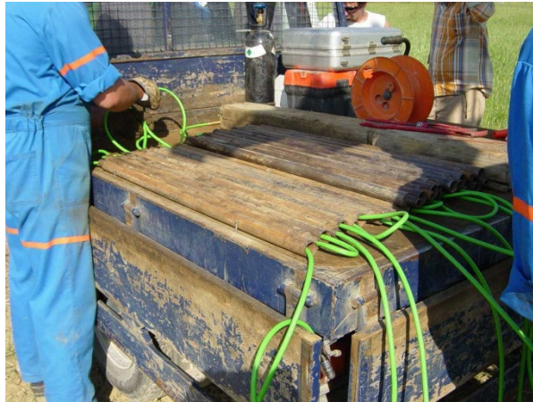
Figura 67 - Colocação do cabo de transmissão por entre os tubos
