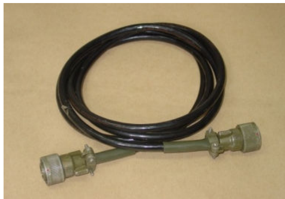
Figura 66 - Cabo de transmissão Data-logger SCPT-CPTU (Rocha, R., 2005)
