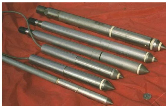
Figura 43 - Fotografia de algumas configurações possíveis de CPTU (Rocha, R., 2005)
