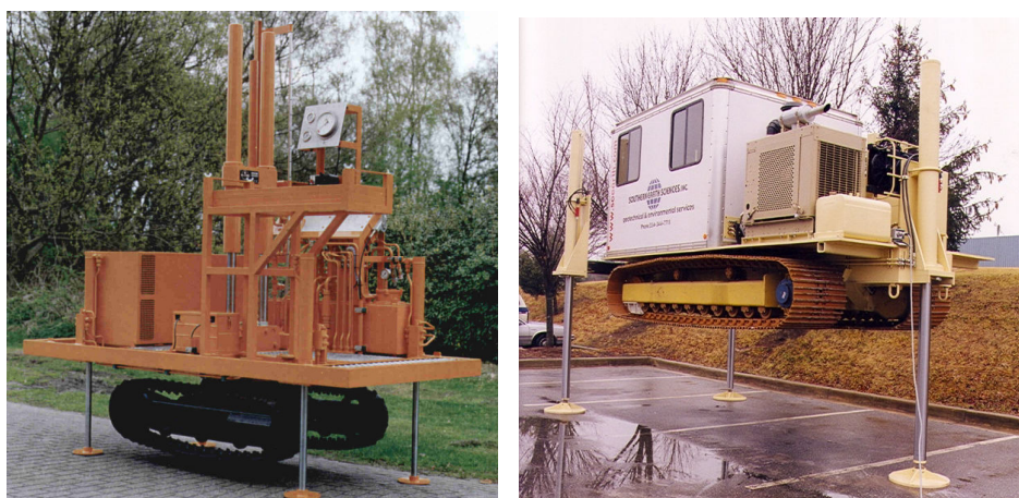
Figura 53 – Equipamentos de lagartas de penetração em posição central
