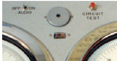
Figura 13 - Botão de teste do circuito
