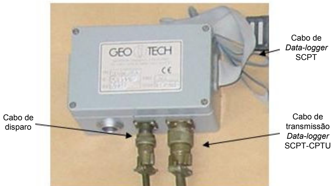
Figura 83 - Montagem no Data-logger SCPT (Rocha, R., 2005)
