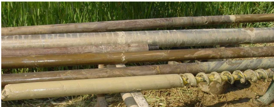
Figura 128 – Varas de posicionamento e de perfuração
