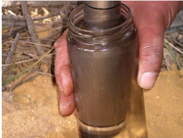
Figura 73 - Manter a ponteira em glicerina até a altura de penetrar no solo
