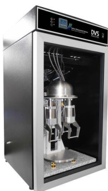
Figura 16 - Instrumento de DVS ( Dynamic Vapour Sorption Resolution instrument ) (Complexo de Laboratórios Tecnológicos - Universidade de Aveiro).
