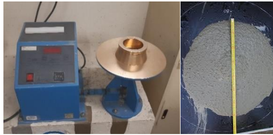
Figura 3.3: Equipamento utilizado para o teste de espalhamento, à esquerda, e método de medição do espalhamento de argamassas, à direita [16].
