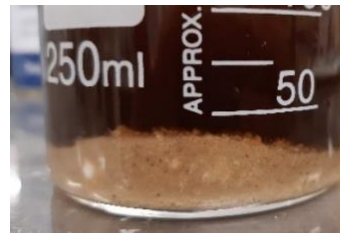
Figura 4.1: Deposição do produto comercial nos testes de coagulação-floculação.
