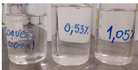
Figura 4.6: Fotografia do adjuvante C preparado de acordo com a formulação convencional, à esquerda, e com incorporação de efluente adj_claro de 0,53 % (m/m), ao centro, e 1,05 % (m/m), à direita.
