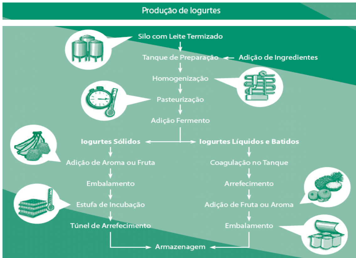
Figura 10 – Etapas do processo de produção dos vários tipos de iogurtes
