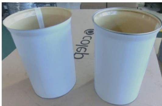
Figura A.5: Antes e após cravação da argola
