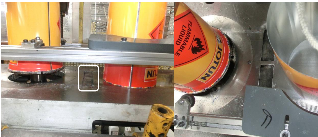
Figura 33: Rolo oleador aplicado antes de máquina de fazer ameaço
