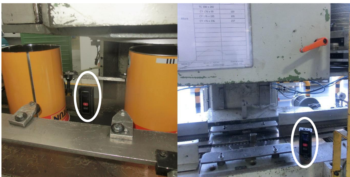
Figura 39: Utilização do laser na cravadeira de fundos e de argolas respetivamente
