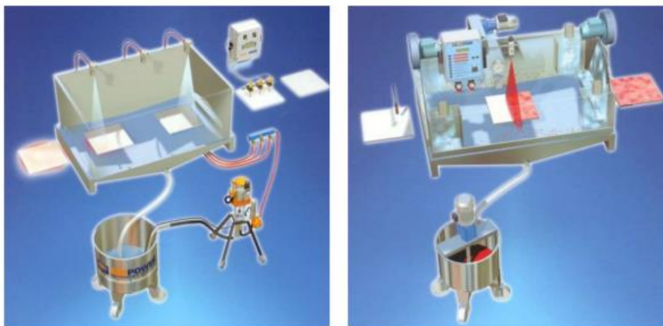
Figura 2 - Representação de um sistema de aplicação de vidrado por pistola. [8]
