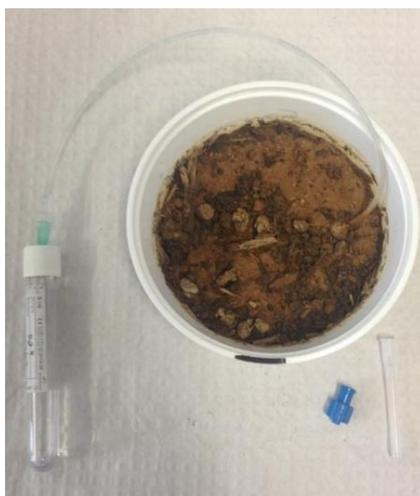
Figura 5. Vista superior de um vaso com amostrador para recolha da solução do solo no ensaio com solo da mina de Lousal
