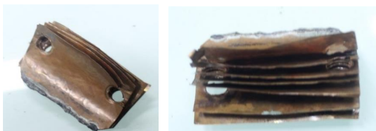
Figura 30- Harmónios com folha de cobre que estabelecem contacto elétrico entre os elétrodos submetidos ao mesmo potencial.
