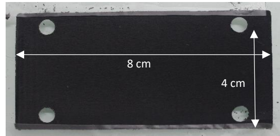
Figura 8- Esquema da utilização de um laser de CO 2 (comprimento de onda 10,6 μm) para fabrico de LIG (esquerda). Imagem representativa de uma das amostras produzida (direita).
