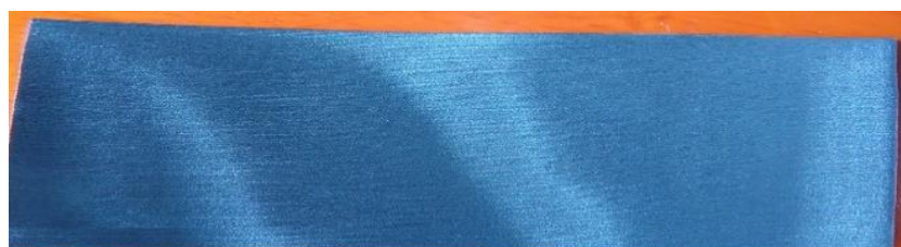
Figura 23- Fotografia de um elétrodo onde se observa a presença de zonas com diferentes tonalidades (claras e escuras).
