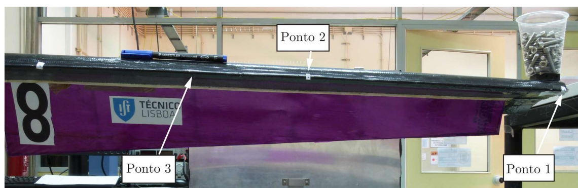
Figura 37 – Teste experimental do comportamento da asa a tensões através da colocação de massas na ponta livre da asa.
