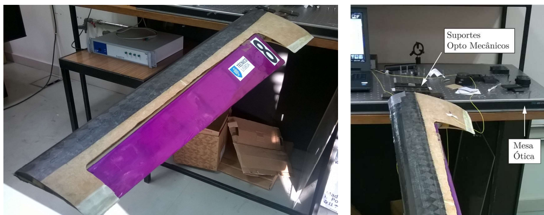
Figura 26 – Imagem da asa utilizada, fixa numa mesa ótica e na posição em que foram realizados todos os testes, presa à mesa ótica com recurso a suportes opto mecânicos.
