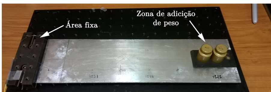
Figura 10 – Fotografia da montagem experimental, onde foram realizados os testes da placa de alumínio.
