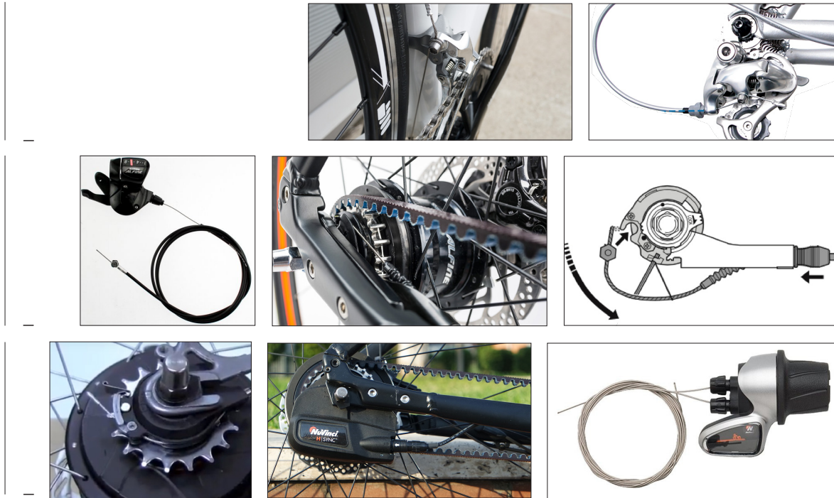
fig. 77 - pormenores de conexão do cabo (sistema A)
