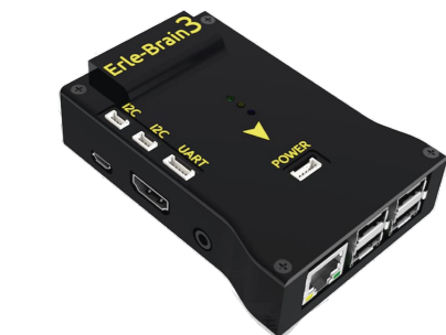
Figure 4.2: Erle Brain 3 autopilot module [23].
