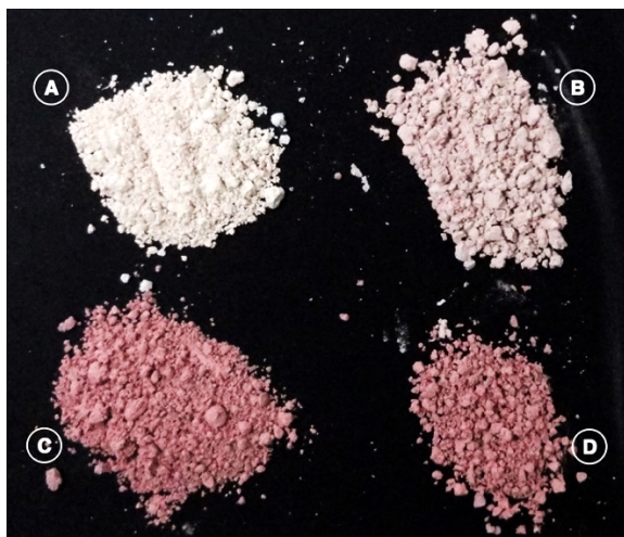
Figura 23 - Imagens dos pós TCP-Fe obtidos com diferentes teores de ferro e estado de oxidação do íon precursor, calcinados a 1000°C.
