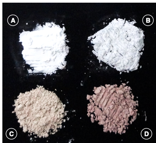
Figura 18 - Fotografias dos pós TCP-Fe calcinados a 1000°C e peneirados a 40 \mu\text{m} : A - TCP0Fe, B - TCP3Fe 2+ , C - TCP7Fe 2+ e D - TCP10Fe 2+ .
