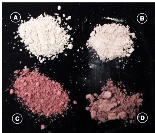
Figura 28 - Imagens dos pós TCP7Fe obtidos com precursor \text{Fe}^{2+} ou \text{Fe}^{3+} , calcinados a 1000 e 1100°C e peneirados a 40 \mu\text{m} . A – TCP7 \text{Fe}^{2+} - 1000; B – TCP7 \text{Fe}^{2+} - 1100; C - TCP7 \text{Fe}^{3+} - 1000; D – TCP7 \text{Fe}^{3+} - 1100.
