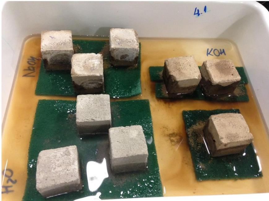
Figura 15: Ensaio de absorção de água por capilaridade.
