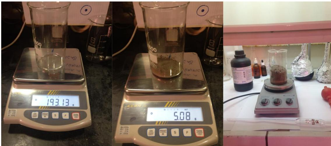
Figura 14: Ensaio de determinação de matéria orgânica com peróxido de hidrogénio.
