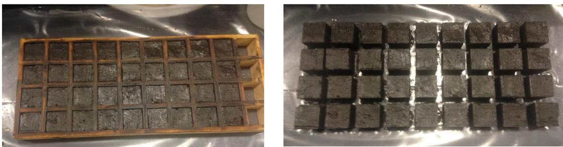
*Figura 13: Moldagem dos adobes e remoção da forma.*
