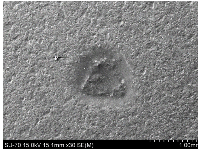
Figura 36 - Análise SEM de um ponto brilhante no mate preto de revestimento.
