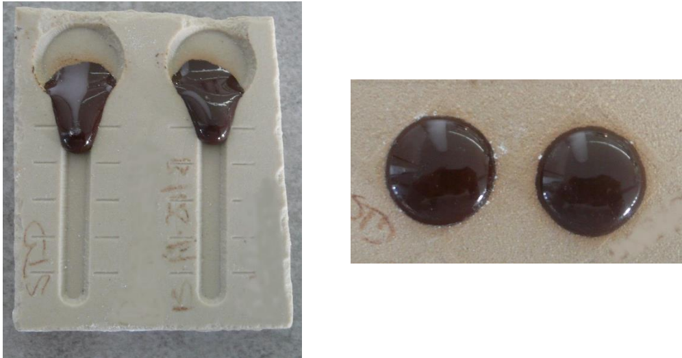
Figura 21 – Botões de escorrimento (à esquerda) e botões de espalhamento (à direita).
