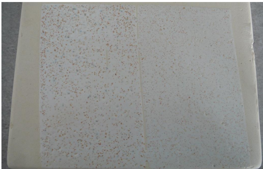
Figura 26 – Controlo de granilha em vidro (reprovado).
