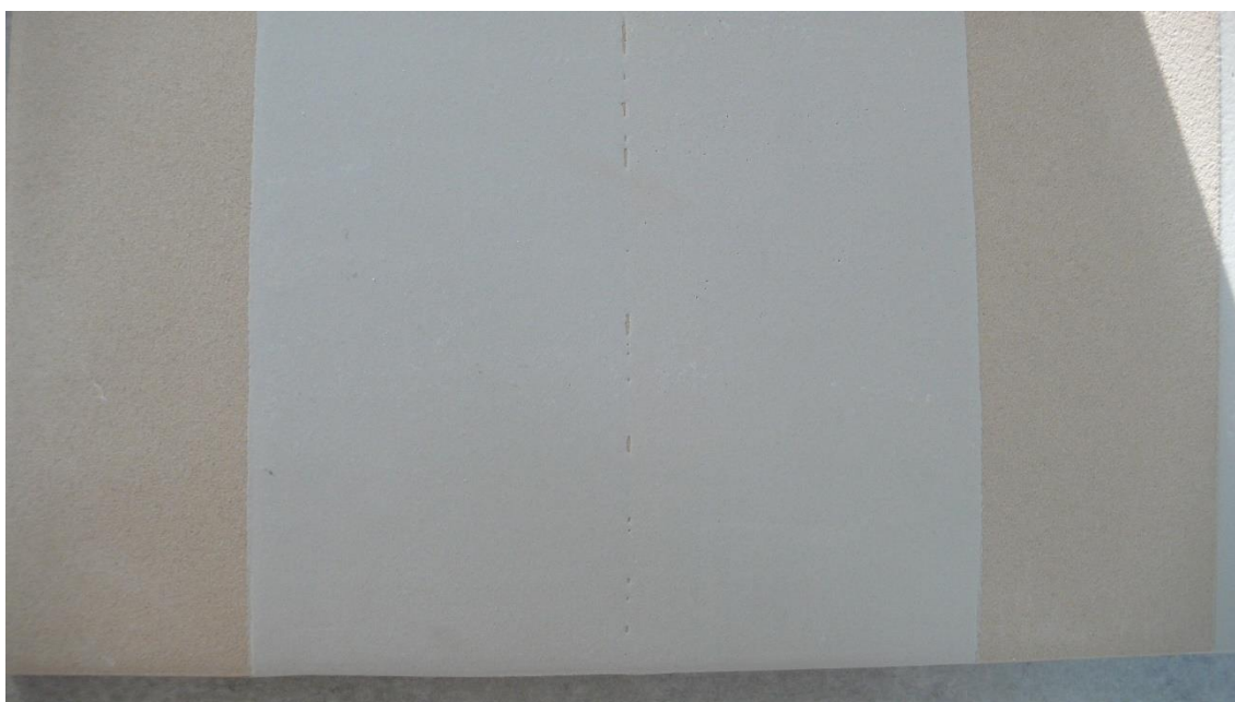
Figura 32 – Controlo de vidro mate de grés porcelânico com diferença de tom.
