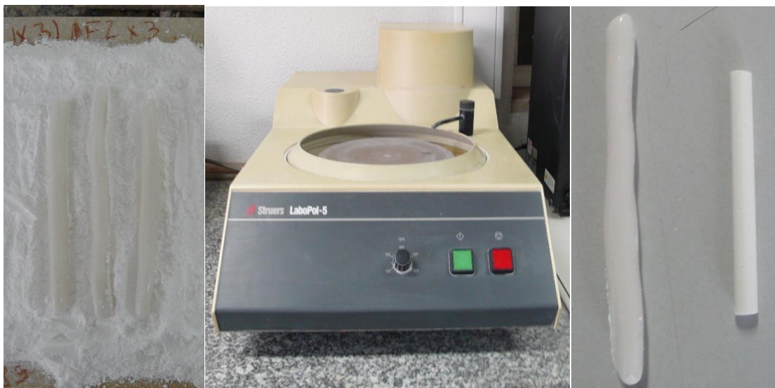
Figura 22 – Provetes cozidos numa camada de alumina (à esquerda), Struers LaboPol-5 para rebarbar provetes (ao centro) e comparação entre provete por rebarbar e provete rebarbado (à direita).
