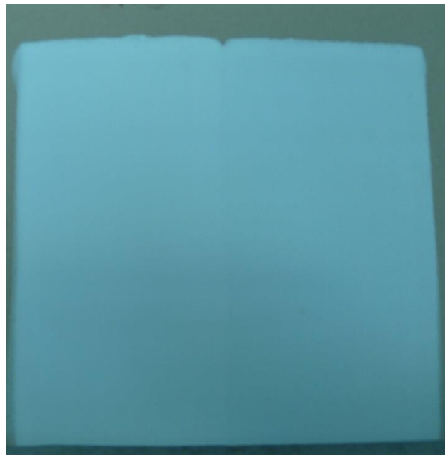
Figura 27 – Cacharreta de controlo de vidro mate de grés porcelânico com diferença de opacidade.
