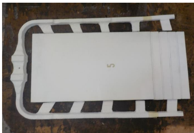
Figura 3.3 - Modelo em poliestireno expandido da peça contendo canal de distribuição e ataques. Na extremidade da direita é visível os 4 acrescentos que foram utilizados nas caracterizações realizada aos compósitos obtidos.
