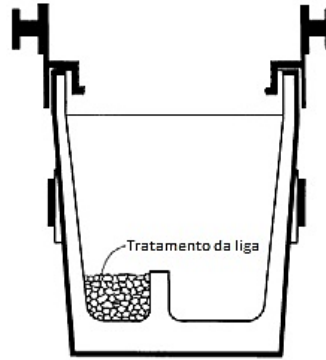
Figura 2.5 - Representação esquemática da localização do inoculante e do nodularizante na colher de vazamento [7] .
