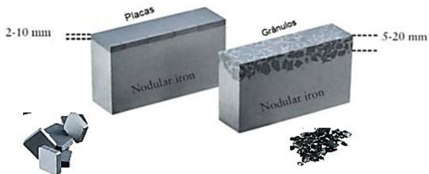
Figura 2.11- Diferentes tipos de incorporação do metal duro em peças de ferro fundido [1][18] .
