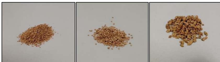
Figura 15 - Granulados 0,5-1; 1-2; 3-7 mm (esquerda para a direita), utilizado para os ensaios à escala laboratorial.
