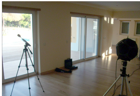
Figura 13 – Ensaio a sons aéreos da fachada [w.9]
