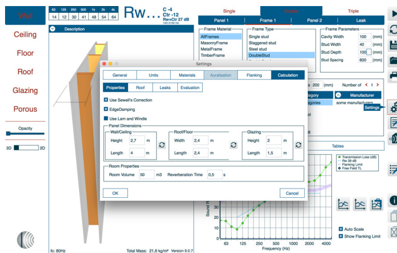
Figura 33 – Submenu referente às dimensões do elemento e da envolvente (fonte: INSUL)
