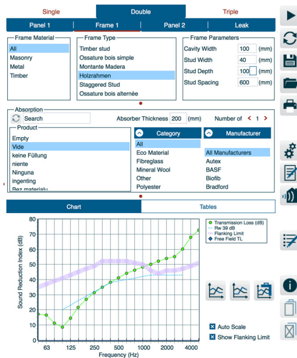
Figura 30 – Menu inicial – referente ao tipo de caixa de ar e às suas dimensões (fonte: INSUL)
