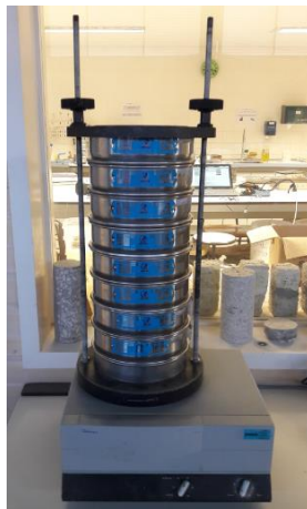
Figura 8 - Sequência de peneiros desde a base, em baixo, até ao peneiro de maior abertura, em cima
