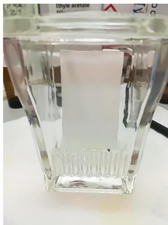
Figura 5. Representação do reservatório do solvente e da placa de TLC durante o desenvolvimento do ensaio.
