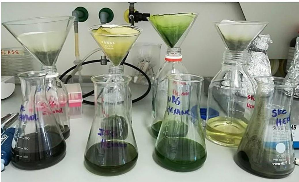
Figura 1. Filtração dos extratos através de filtros de papel de 20-25 $\mu$ m.
