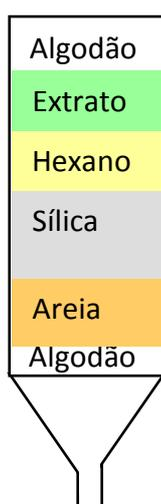
Figura 3. Representação esquemática da coluna de sílica
