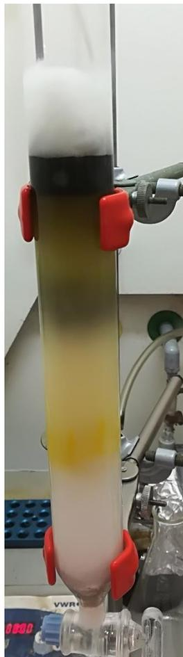
Figura 4. Coluna de sílica com frações diferenciadas.
