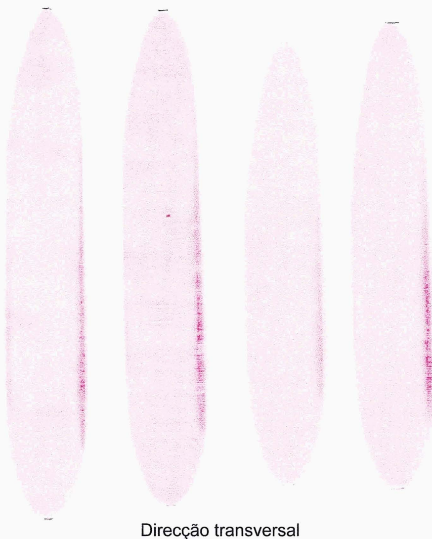
Mancha de penetração de tinta nos papéis GCC
