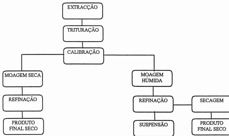
Figura 1.2 - Fluxograma do tratamento típico de carbonatos de cálcio naturais.
