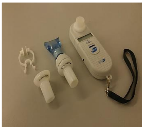
Figura 12 - Materiais essenciais à realização da manovacuometria (da esquerda para a direita: mola, duas resistências – inspiratória e expiratória -, bocal de silicone e manovacúmetro)
