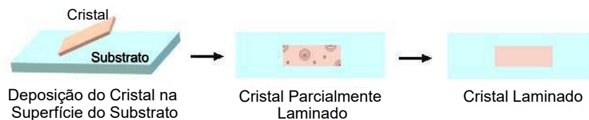
Figura 5.1: Esquema do processo de laminação de cristal no substrato. Para uma interface o princípio é o mesmo, com o cuidado extra de não desfazer durante a laminação. No caso de se laminar sobre um filme orgânico, os passos são os mesmos.
