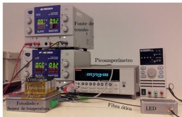
Figura 20. Montagem experimental para o estudo da resposta do fotodíodo para diferentes comprimentos de onda de emissão do LED e temperaturas.
