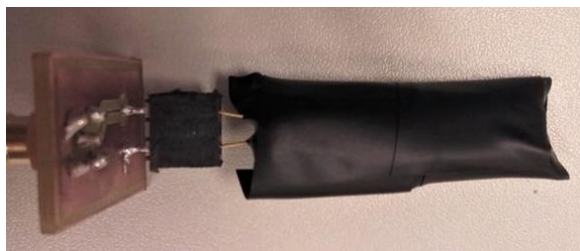
Figura 17. Cristal BGO acoplado a fotodíodo (conectado ao jumper ), envolvidos em teflon e fita cola preta.
