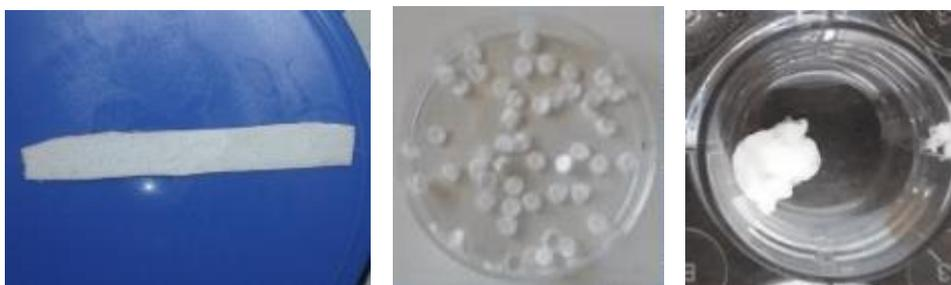
Figura 3.3. Cortes das malhas para as camadas profunda (esquerda), superficial (centro) e as malhas produzidas por *electrospinning* (direita).
