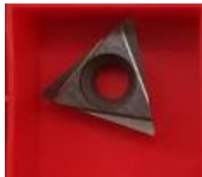
Figura 23- Pastilha do cermeto 5Mo5Nb utilizada nos ensaios de vida útil.
