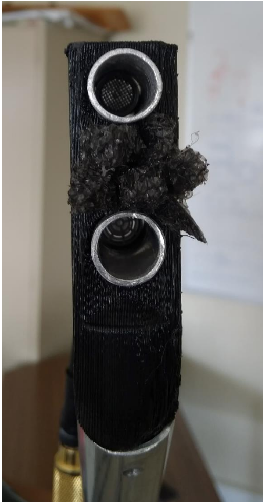
Figura 68: Posicionamento dos transdutores no interior do tubo com a peça V3.
