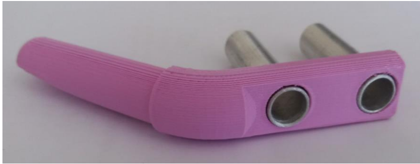
Figura 63: Versão 2 tubos de alumínio à face
