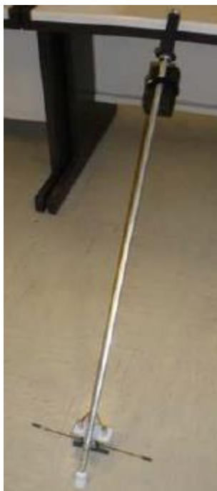
Figura 2: Protótipo da bengala de apoio a cegos [7], [12].
