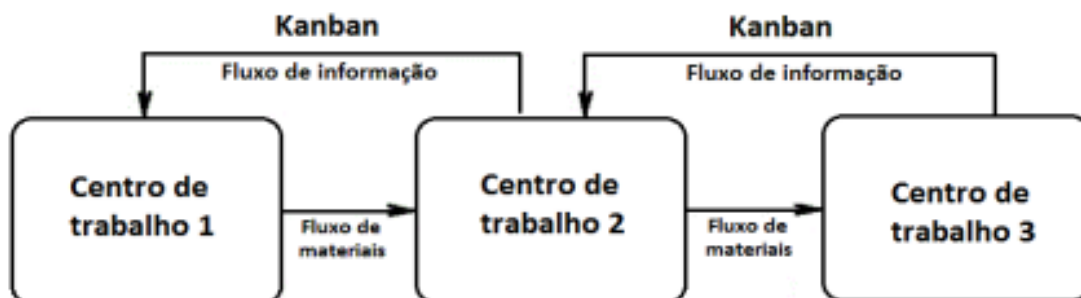
Figura 14 - Modelo de funcionamento do sistema Kanban (Pinto, 2008)
