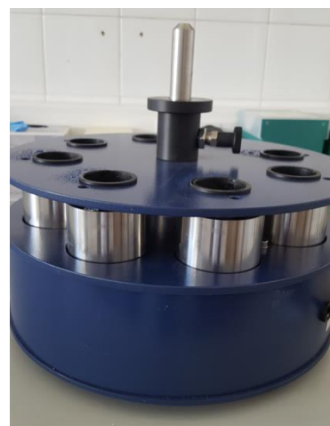
Figura 26- Wet Sieving Apparatus (Aparelho de peneiração húmida)
