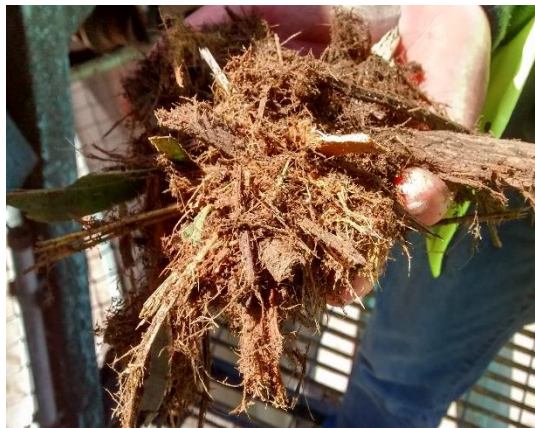
Figura 4.11. Amostra de biomassa à entrada da caldeira.
