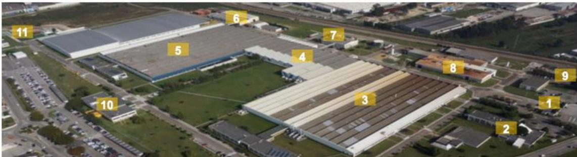
**Figura 10** - Vista aérea da fábrica Renault CACIA (1. Recepção; 2. Direção; 3. Caixas de Velocidades; 4. Armazéns; 5. Componentes Mecânicos; 6. Oficina Central; 7. Central de Fluidos; 8. Tratamentos Térmicos; 9. ETAR; 10. Posto Médico/Restaurante; 11. Campus CCD.
