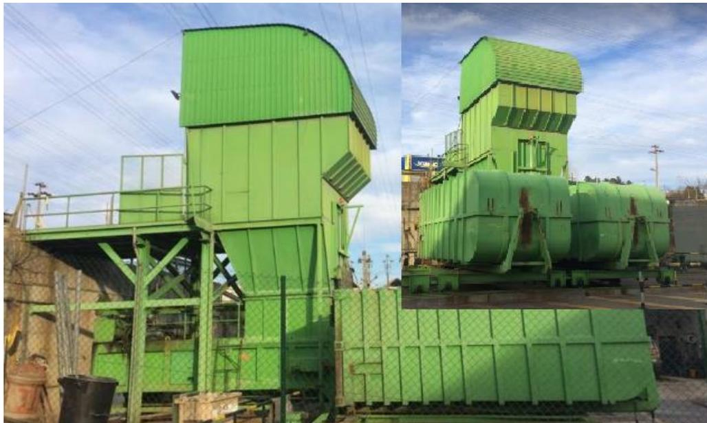
Figura 3.8 - Fotografia do compactador mecânico.
