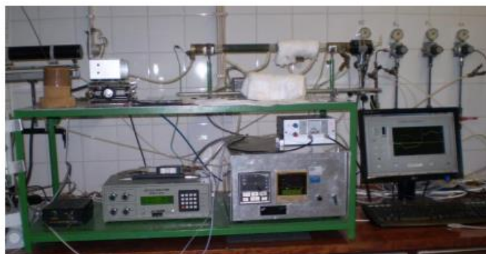
Figura 12 - Analisador termo-ótico desenvolvido no Departamento de Ambiente e Ordenamento da Universidade de Aveiro.
