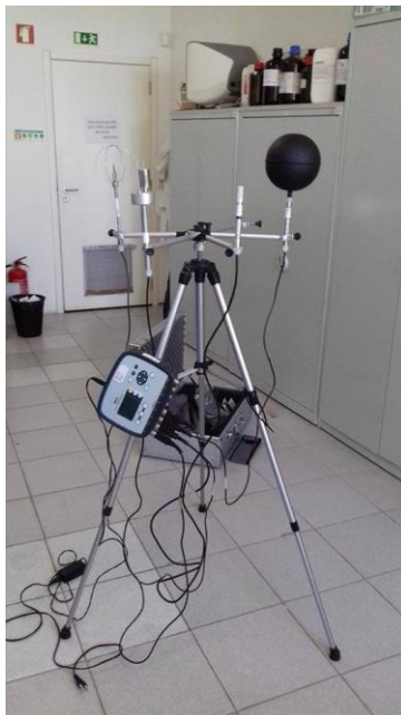
Figura 7 - Aparelho de medição do conforto térmico.
