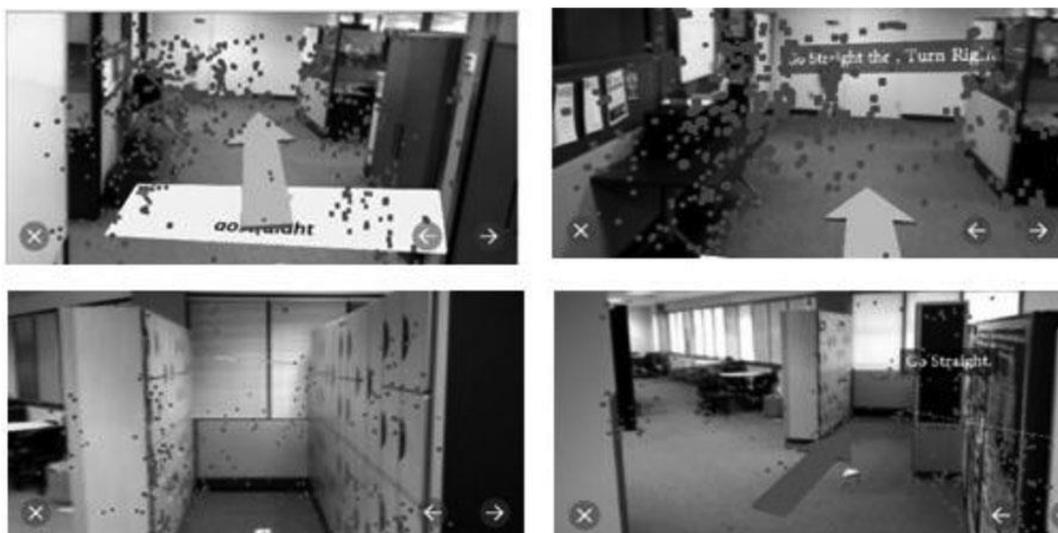
Figura 6: Aplicação de RA para navegação em espaços interiores: Informação disponibilizada consoante a análise da nuvem de pontos detetada. Estes pontos não são apresentados na versão do utilizador (Rehman & Cao, 2017).
