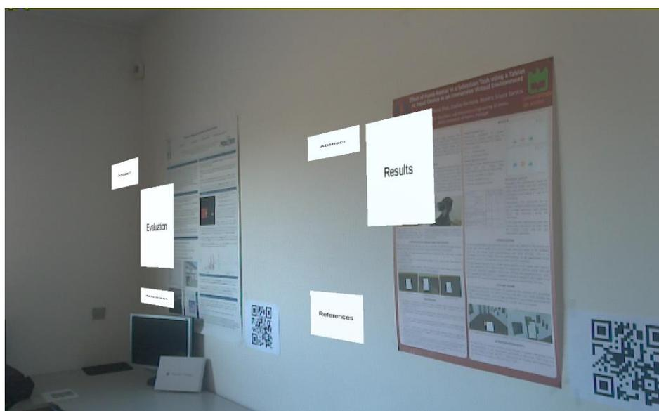
Figura 25: Exemplo da aplicação após alguns movimentos do utilizador: o conteúdo virtual está claramente desalinhado em relação ao mundo real.
