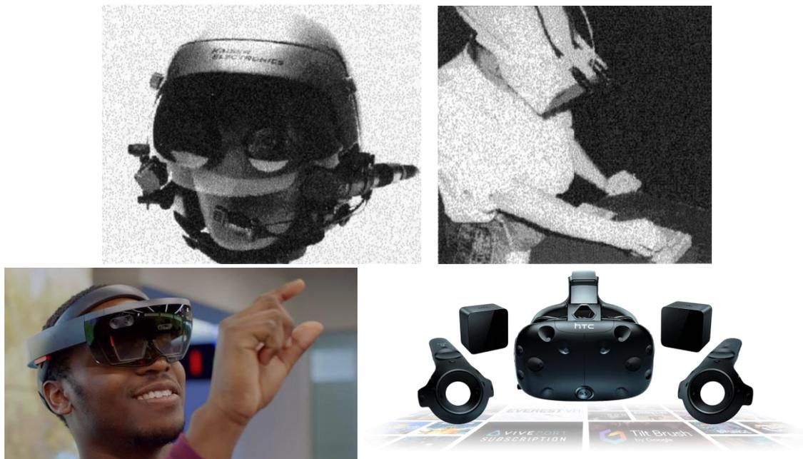
Figura 3: Em cima, equipamentos usados no fim do século XX, com um exemplo de *optical see-through* à esquerda e exemplo de *video see-through* à direita (Rolland & Fuchs, 2000); em baixo, equipamentos atuais, com um exemplo de *optical see-through* à esquerda (Microsoft HoloLens<sup>2</sup>) e exemplo de *video see-through* à direita (HTC Vive<sup>3</sup>).
