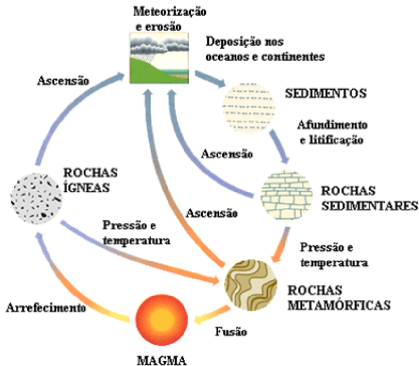
Figura 2.2 - Ciclo litológico simplificado (adaptado de Press et al., 1997).
