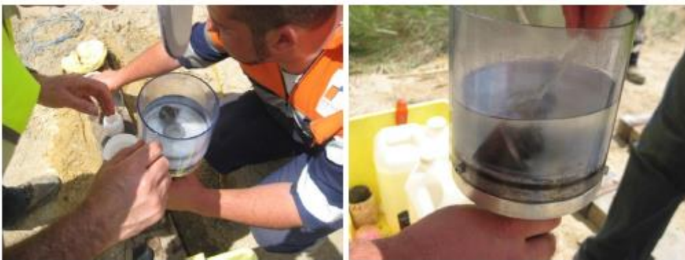
Figura 5.9 - Saturação da câmara de medição da poro-pressão (Silva, 2010).
