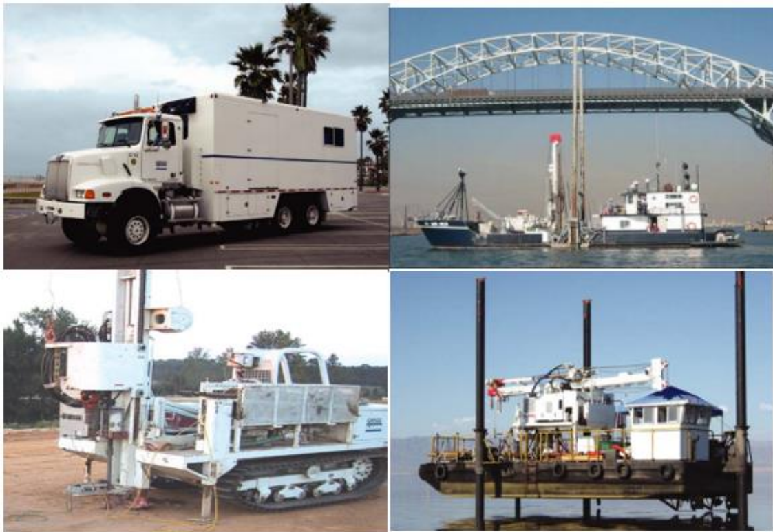
Figura 5.5 - Diferentes equipamentos do ensaio CPTu (em terra à esquerda e em água à direita) (Robertson e Cabal, 2010).
