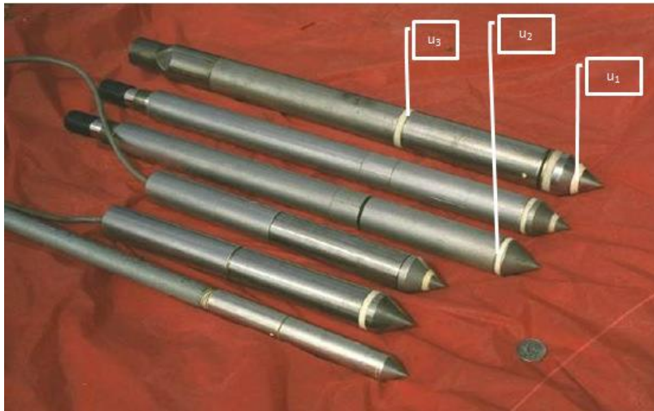
Figura 5.4 - Tipos de piezocones e diferentes posições do elemento poroso (Mayne, 2001).
