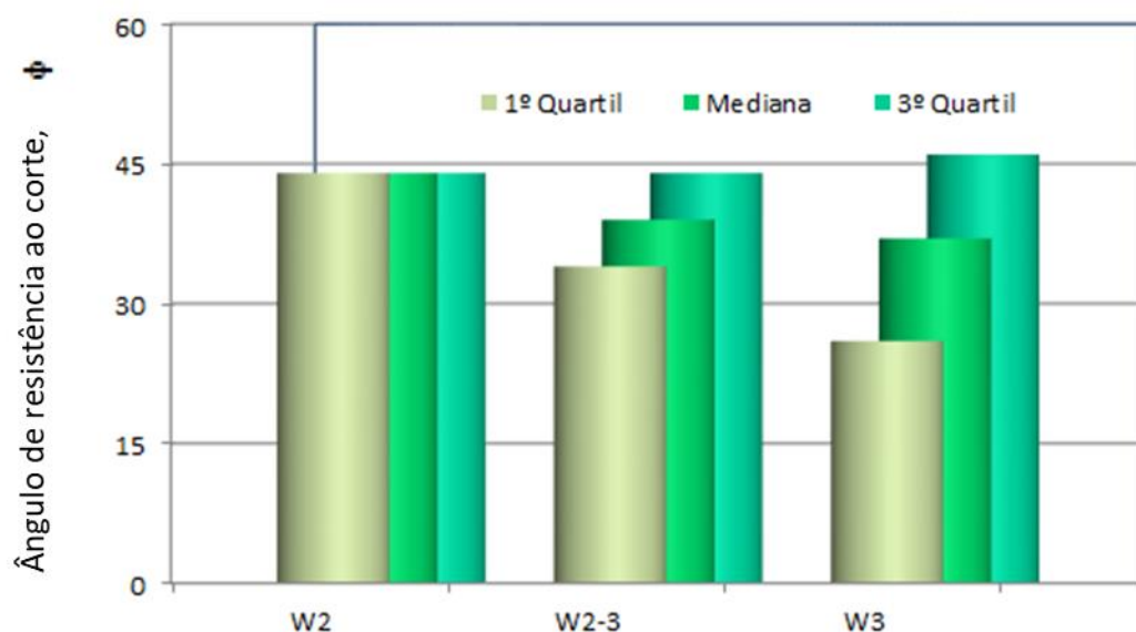
Figura 6.13 - Evolução dos ângulos de resistência ao corte nas fraturas (adaptado de Cruz, 2010).
