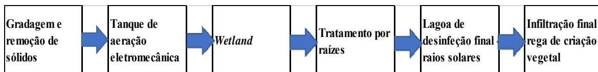
Figura 91 - Esquema do tratamento dos efluentes com maiores contaminações
