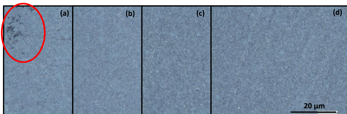
Figura 34- Microestruturas das amostras em etanol com 15 %vol com 2,5 %p de inibidor de corrosão e tempo de moagem de: (a) 14h; (b) 24h; (c) 38h; (d) 48h
